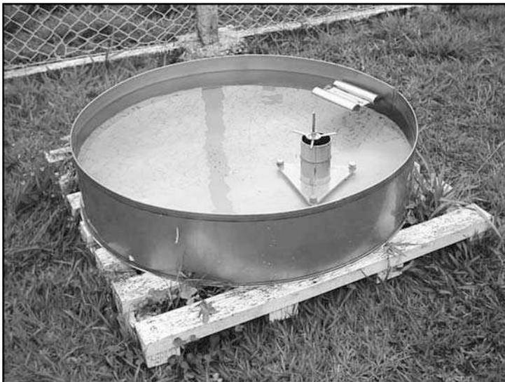
**Figura 47.** Tanque evaporímetro “Classe A”.
