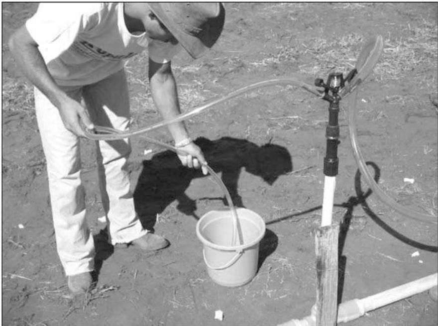
**Figura 58.** Determinação da vazão do aspersor.
