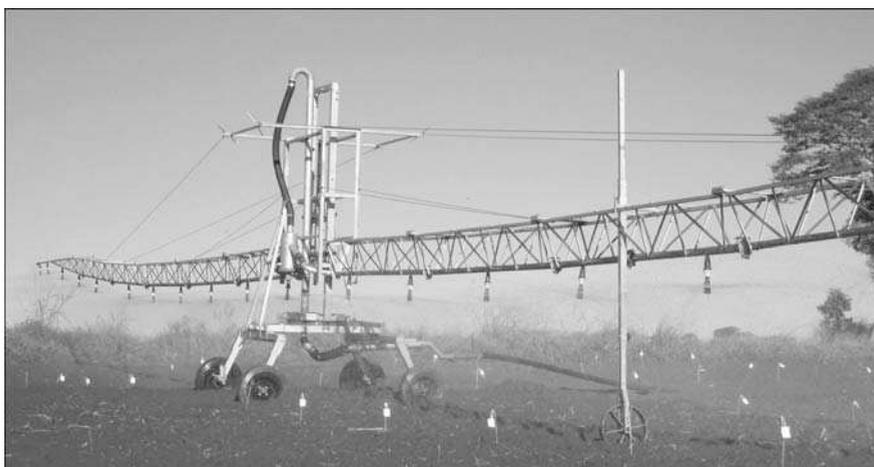
**Figura 23.** Linha lateral móvel (Barra Irrigadora).
