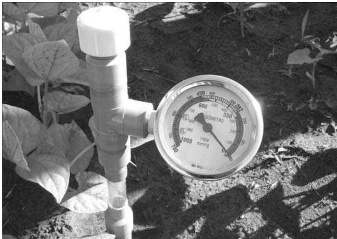
Figura 41. Tensiômetro com vacuômetro acoplado.
