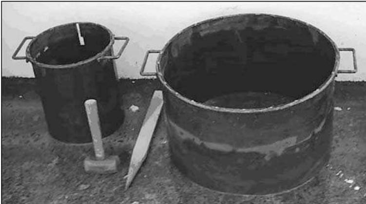
**Figura 53.** Infiltrômetro de anéis concêntricos.
