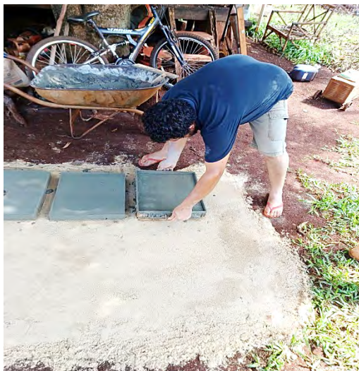
Figuras 8, 9, 10 e 11: Como fabricar as placas, atentando para o molde, o preparo e placas prontas
