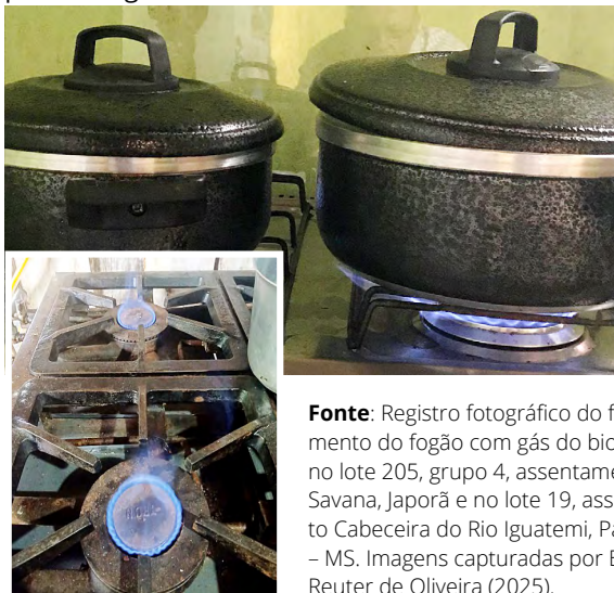
Figura 56 e 57: Fogão com utilização do gás produzido pelo biodigestor.
