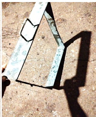
Figuras 3, 4, 5, 6 e 7: Molde para fabricação das placas
