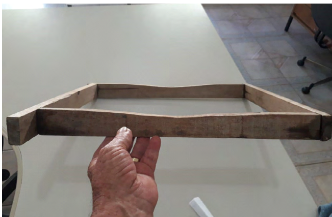
Figuras 3, 4 e 5: Molde para fabricação das placas
